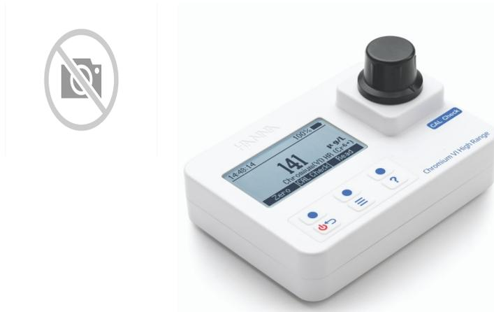
Con nuevo diseño óptico para mejorar la repetitividad y rapidez de la medida, el fotómetro portátil HI97723 mide cromo hasta 1.000 microg / L (ppb). Este medidor combina precisión y facilidad de uso en un diseño ergonómico y portátil.
