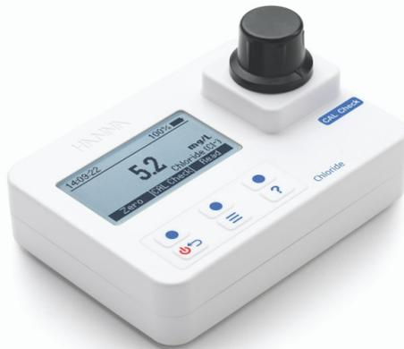
HI97753 es un fotómetro portátil para la medición de cloruros. Este equipo ofrece un sistema óptico avanzado que utiliza un detector de referencia y filtros de interferencia de banda estrecha para mediciones extremadamente rápidas y repetibles.
