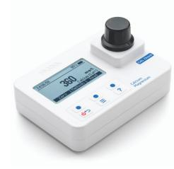
El fotómetro multiparamétrico para medida de calcio y magnesio HI97752 combina precisión y facilidad de uso en un diseño ergonómico y portátil. Un usuario puede determinar con precisión las concentraciones de calcio y magnesio de muestras de agua utilizando reactivos preparados.
