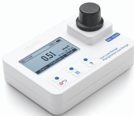
El HI97742 es un fotómetro portátil avanzado para la medición de hierro y manganeso en agua. Este medidor ofrece un sistema óptico avanzado que utiliza un detector de referencia y filtros de banda estrecha para mediciones extremadamente rápidas y repetibles.
