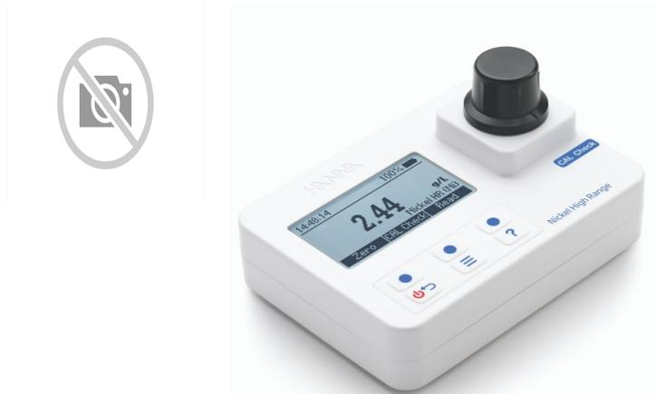
El fotómetro portátil de níquel rango alto HI97726 combina precisión y facilidad de uso en un diseño ergonómico y portátil. Un usuario puede determinar con precisión la concentración de níquel dentro de un rango de 0.00 a 7.00 g / L utilizando los reactivos listos para usar HI93726-0.
