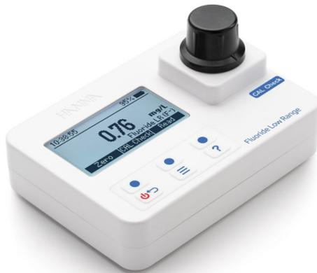
El HI97729 es un fotómetro portátil de rango bajo para la medición de fluoruro en agua. Este medidor ofrece un sistema óptico avanzado que utiliza un detector de referencia y filtros de interferencia de banda estrecha para mediciones extremadamente rápidas y repetibles.
