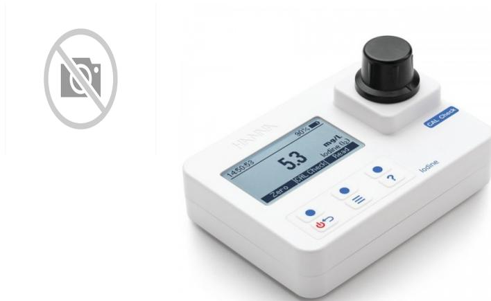
El fotómetro de yodo HI97718 combina precisión y facilidad de uso en un diseño ergonómico y portátil. Usando los reactivos listos para usar HI93718-0, el usuario puede determinar con precisión la concentración de yodo en muestras dentro de un rango de 0.0 a 12.5 mg / L (ppm).
