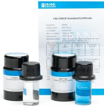
El kit de patrones HI97718-11 CAL Check™ proporciona una solución sencilla para calibrar y validar el fotómetro portátil HI97718.
