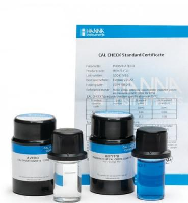
Los patrones CAL Check trazables a NIST de Fosfato de alto rango se usan como método de validación y calibración del HI97717-11. Se suministran con el certificado de análisis que proporcionan el número de lote, valores de referencia y la fecha de caducidad para la trazabilidad.
