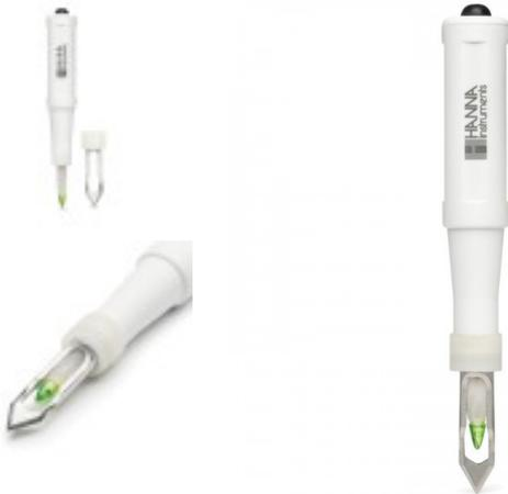
Electrodo de pH compatible con los controladores de procesos HI510 y HI520. Con sensor interno de temperatura y punta de vidrio cónica, es ideal para industria alimentaria. Tiene además, una cuchilla de acero inoxidable en la punta que permite que el electrodo entre en contacto con la muestra sin esfuerzos y sin dañar la punta del electrodo.
