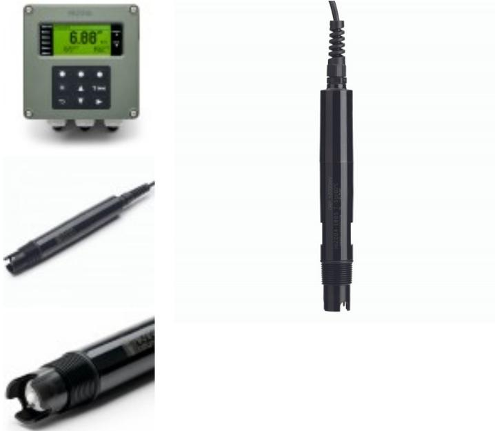
Sonda digital de procesos industriales para medida de ORP/ temperatura que se utiliza con el controlador de procesos universal HI510 y HI520.
