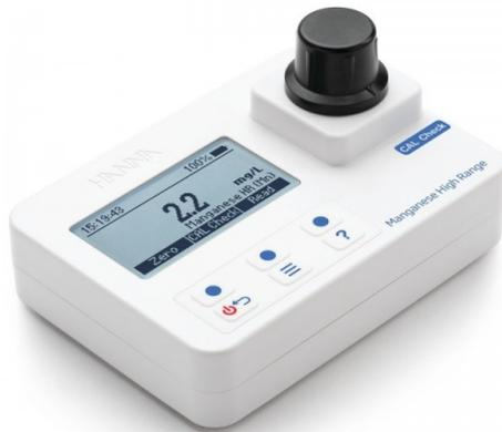
Fotómetro portátil calibrable de Manganeso rango alto, nueva serie HI97, HI97709. Fotómetro con sistema CALCHEK calibrable por el usuario, con nuevo diseño óptico para mejorar la repetitividad y rapidez de la medida.
