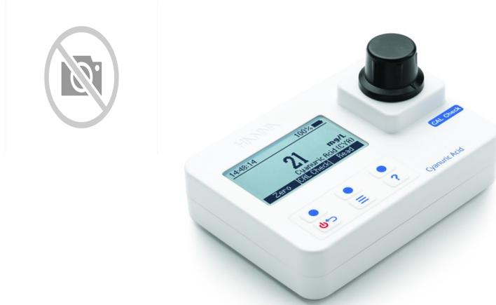
El fotómetro de ácido cianúrico HI97722 combina precisión y facilidad de uso en un diseño ergonómico y portátil. Usando los reactivos listos para usar HI93722-0, el usuario puede determinar con precisión la concentración de ácido cianúrico en muestras dentro de un rango de 0 a 80 mg / l (ppm).
