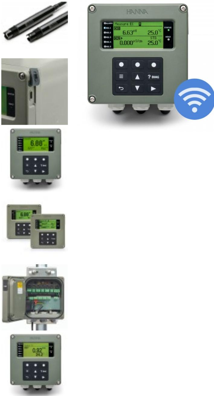
El HI510 y HI520 son controladores de procesos avanzados y universales que pueden ser configurados para muchas aplicaciones que requieren monitorización y/o control de los parámetros principales de análisis de agua: pH, ORP, conductividad, oxígeno disuelto y turbidez. Cuentan con una o dos entradas de sonda digital que detectarán y actualizarán automáticamente el medidor con el parámetro que mide.
