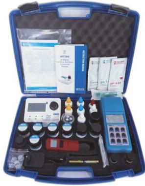
Conjunto en maletín para medida de turbidez, cloro libre y total, ácido cianúrico, alcalinidad, pH y temperatura.
