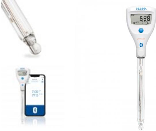
El pHmetro HI9810462 es un medidor sencillo pero preciso para mediciones en altas temperaturas con vidrio HT. El triple diafragma cerámico ofrece rapidez de lectura y menor posibilidad de obturación. Se puede utilizar como medidor de pH independiente o se puede conectar a un dispositivo móvil con **la aplicación HANNA Lab.**
