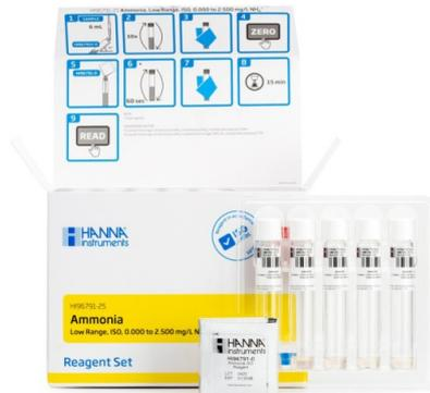
Los HI96791-25 y HI96792-25 son viales de reactivos pre-dosificados para la determinación colorimétrica de Amonio utilizando un fotómetro de sobremesa compatible. Estos reactivos de alta calidad se fabrican en nuestras instalaciones con tecnología punta y están claramente marcados con el número de lote y la fecha de vencimiento en cada caja para su trazabilidad.
