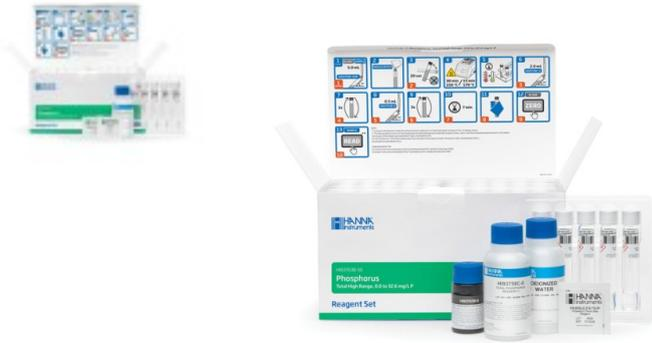
Los viales HI93763B-50 y HI93758C-50 son reactivos predosificados que siguen una adaptación de los Métodos Estándar para el Examen de Aguas Residuales y Aguas Residuales, 20ª edición, 4500-PC, ácido vanadomolibdofosfórico para la determinación de fósforo total de alto rango utilizando un fotómetro de sobremesa compatible.
