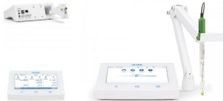
Medidor multiparamétrico modular de la Serie 6000 equipado con el módulo de pH/Redox HI6000-1 y, con electrodo de pH HI1048Y **para vino y mosto**. Posibilidad de instalar módulos para la medida de Conductividad (Estabilidad Tartárica) y Oxígeno Disuelto HI6000-3.
