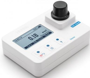
El HI97757 es un fotómetro portátil para medida de ozono con autodiagnóstico. Cuenta con un sistema óptico avanzado que utiliza un diodo emisor de luz (LED) y un filtro de interferencia de banda estrecha que permite lecturas precisas y repetibles.
